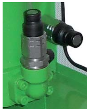
Coupleurs à face plane pour connexion des flexibles aspiration et refoulement.
