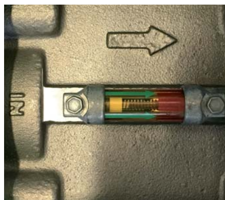
Indicateur de colmatage.
