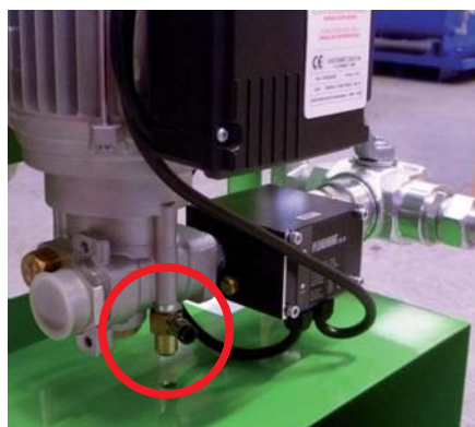
Système de purge pour amorçage pompe
