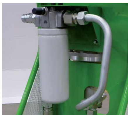
Filtre avec indicateur de colmatage visuel à pression différentielle.
