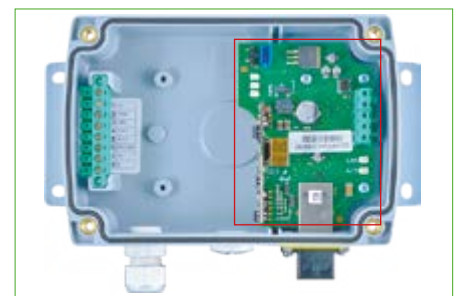
Ethernet - Modbus TCP
