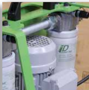
Filtres avec indicateur de colmatage à pression différentielle.
