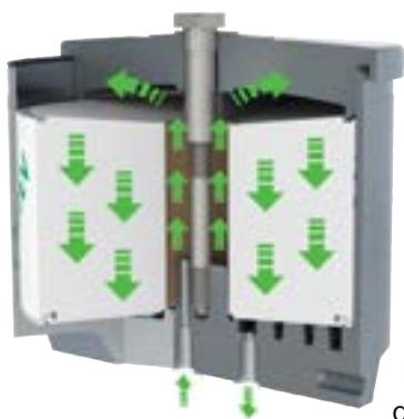
Le SDFCU retire jusqu'à 99.9% de la pollution en eau et permet ainsi d'inhiber la production d'acides (hydrolyse). En passant à travers l'élément filtrant, l'huile est débarrassée des minuscules particules de carbone, des métaux d'usure et de la silice qui sont piégées en adhérant aux nombreuses surfaces du filtre.
